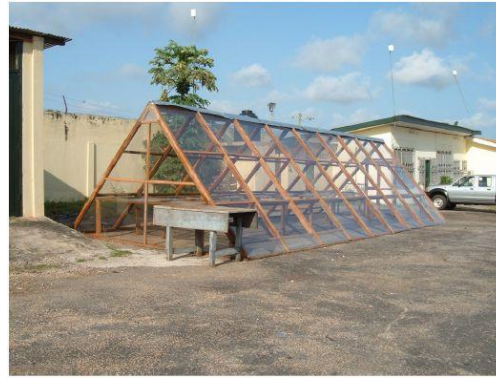
Figura 5: Deshidratador tipo tienda grande, Ghana. Foto Tony Swetman
