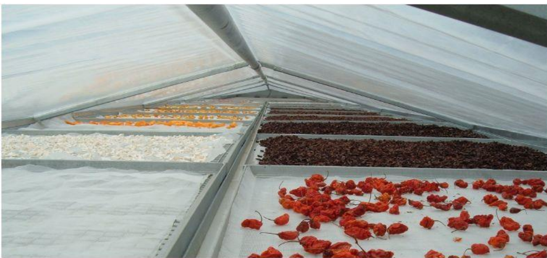
Figura 8: Vista del interior de un deshidratador de tunel Hohenheim. Foto: Tony Swetman.
