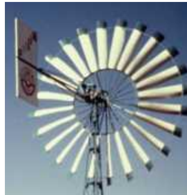
Figura 8: Rotor de alta solidez. Foto: Practical Action.
