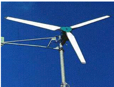
Figura 9: Rotor de baja solidez Foto: Practical Action
